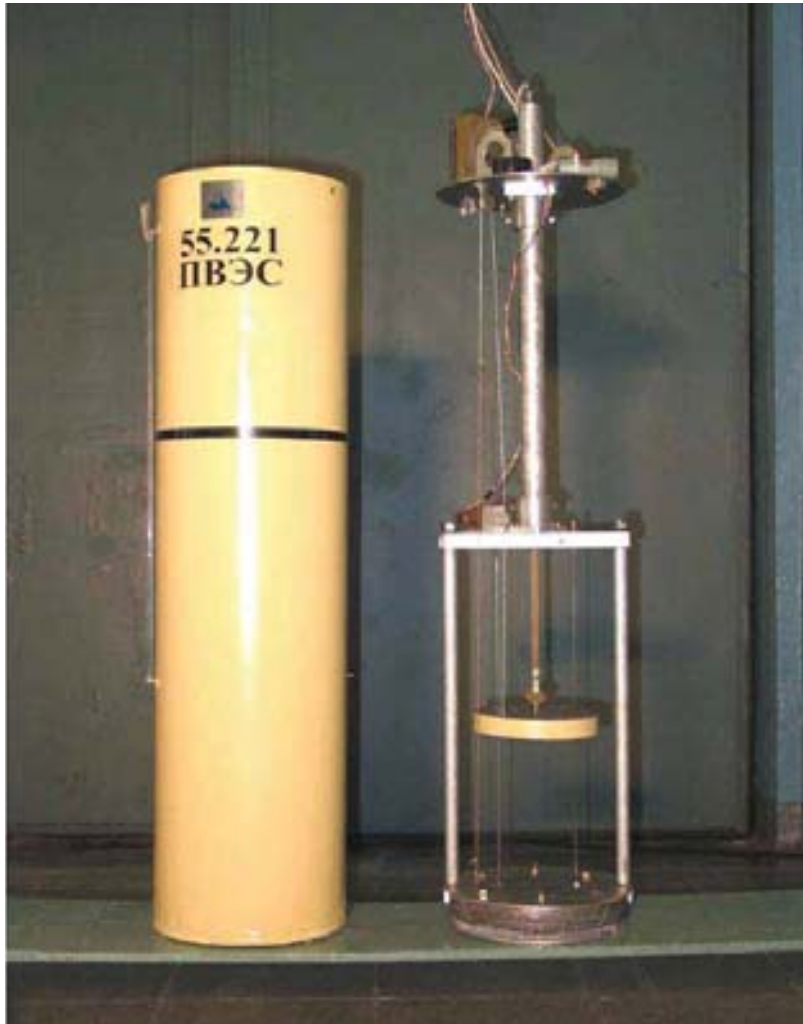
Abbildung 1: Modell des Wellenenergiegenerators im Maßstab 1:10. Links ist die äußere Hülle, rechts der innere Aufbau des Gerätes zu sehen.
