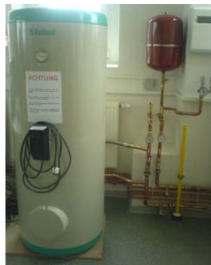
Bilder 3-5: Bestandteile des Versuchsstandes: Luftwärmepumpe, Heizkreislauf und Wärmetauscher
