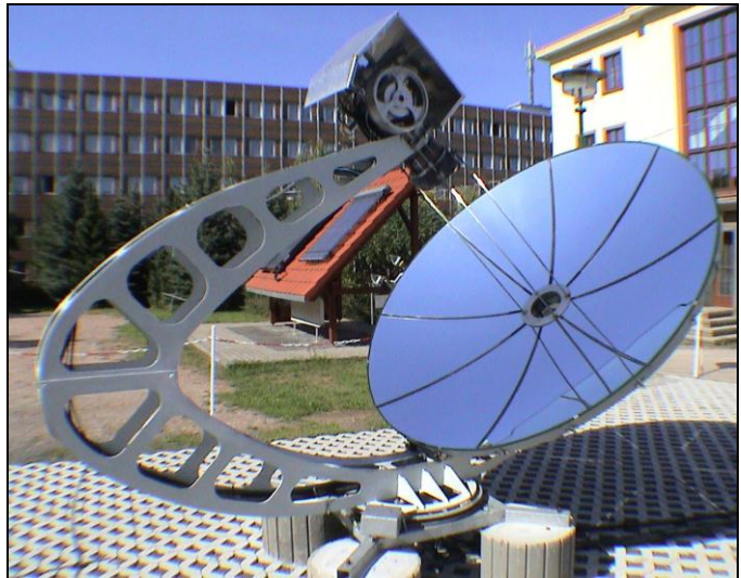
Bild 3 Solar-Stirling-Anlage mit Parabolspiegel, Stirlingmotor und mechanischer Konstruktion
