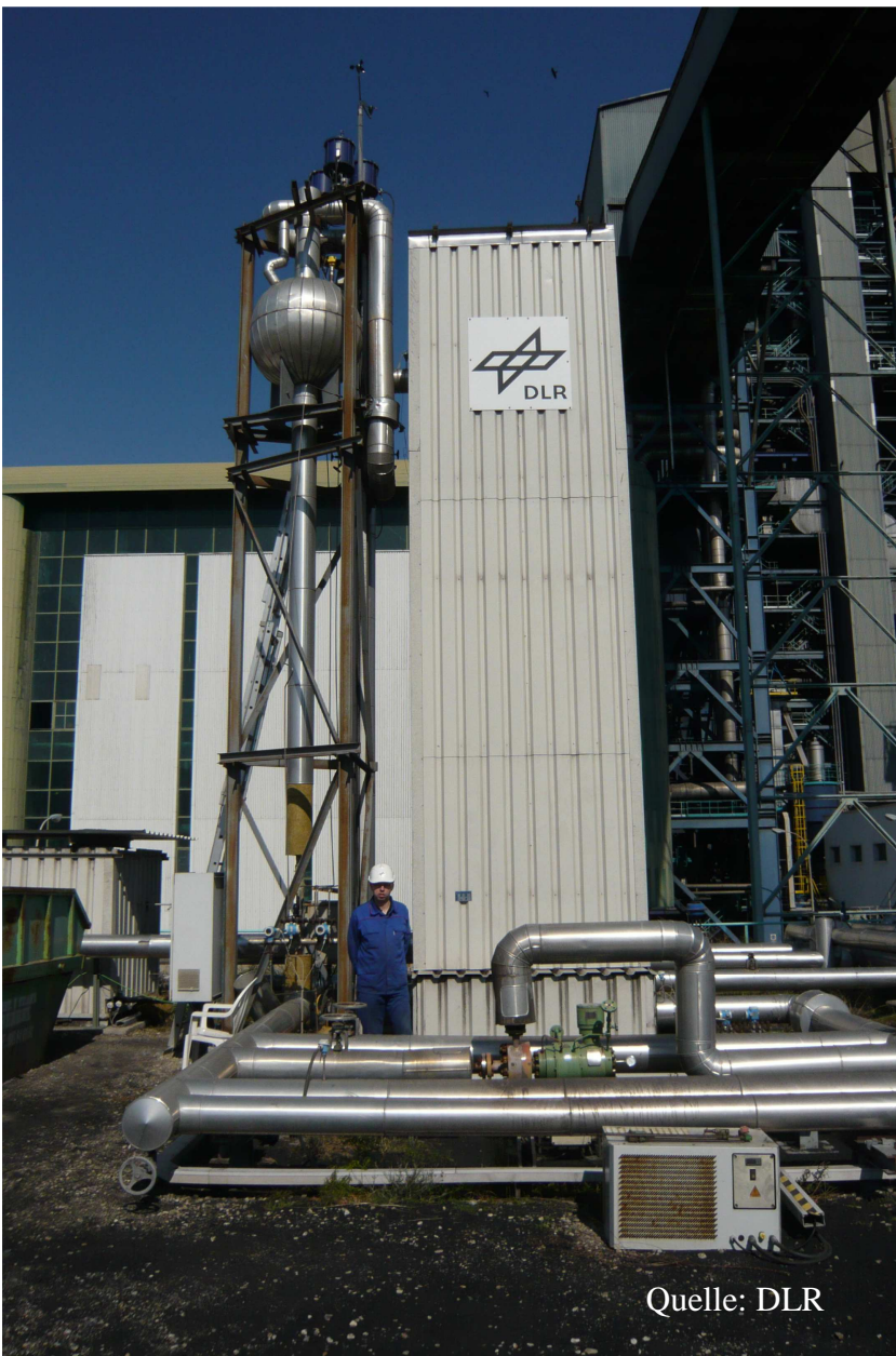
Abb. 2: PCM Speicher des DLR am Standort Carboneras, Spanien (BMU Vertragsnr.: 03UM0064 und 03UM0065)
