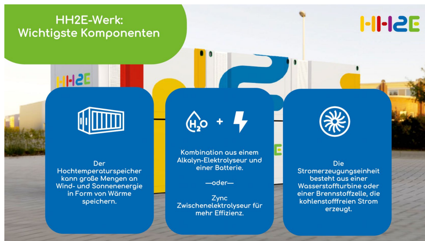
Abbildung 5: Komponenten des HH2E-Zukunftskraftwerkes
