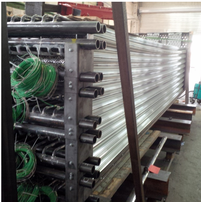
Abbildung 5: Bau des Latentwärmespeichers
